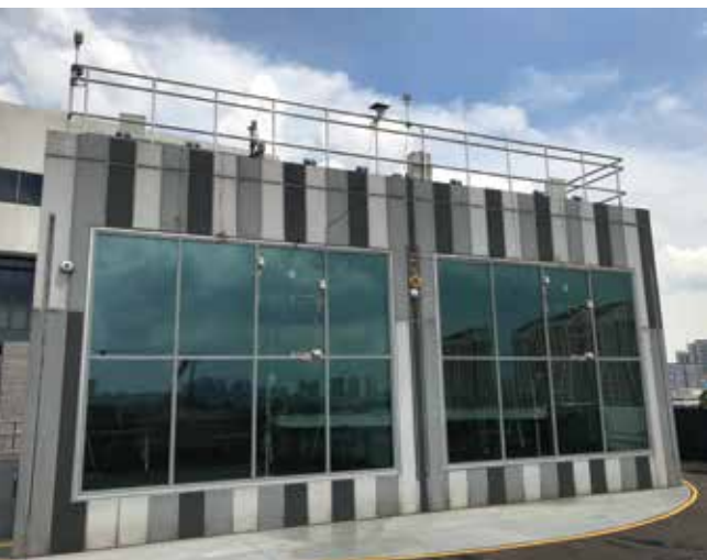
Thí nghiệm và nghiên cứu được thực hiện tại BCA Skylab: Hệ thống cửa sổ có sử dụng cầu cách nhiệt ở bên trái ảnh, và hệ thống cửa sổ thông thường ở bên phải ảnh.
