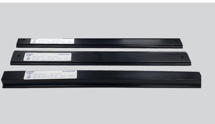
Las piezas contienen una etiqueta en las que se indica unos rangos de peso, mínimo y máximo. En el momento en que el cliente quiera lacar un lote de poliamidas con Coating Prime únicamente debe pesar el máster correspondiente al lote. Si el peso resultante está dentro del rango marcado en la etiqueta, es el momento óptimo de lacar. Si no lo está, deberá revisar el marco de trabajo proporcionado por Technoform en el que se le indicará los siguientes pasos a seguir.
