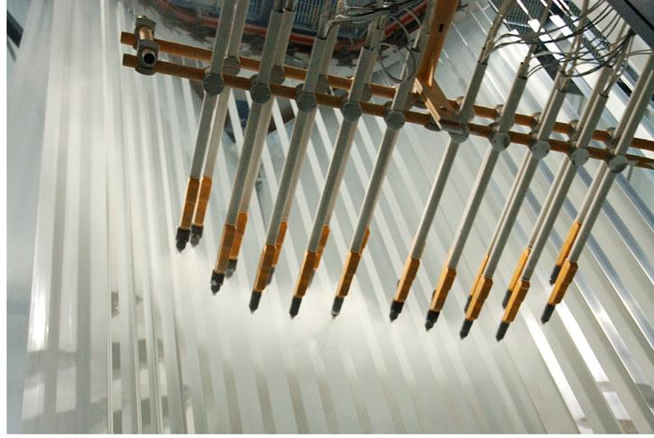
Para lograr un buen lacado de la poliamida esta se debe lacar en unas condiciones específicas para que se cargue estáticamente y bajo un marco de trabajo concreto durante el proceso de lacado.
